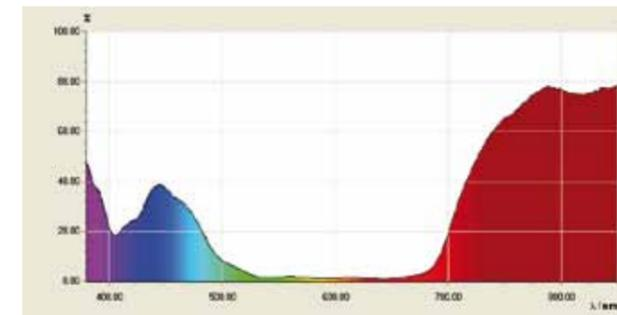
Fig. 1: Spettro di trasmissione di filtro colore azzurro
