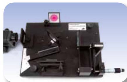
Lastra di vetro sul percorso dei raggi dell'interferometro di Michelson
