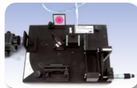
Camera evacuabile sul percorso dei raggi dell'interferometro di Michelson
