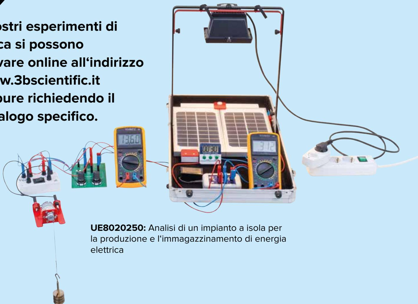
**UE8020250:** Analisi di un impianto a isola per la produzione e l'immagazzinamento di energia elettrica
