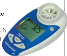
Il Vitalograph asma-1 è un prezioso sistema di monitoraggio dell'asma, che facilita in modo significativo l'esecuzione dei controlli. L'apparecchio misura e salva i valori PEF e FEV1, consentendo di trarre conclusioni precise riguardo alla condizione, eventualmente ostruttiva, delle vie aeree. È inoltre possibile impostare zone PEF/FEV1 a livello individuale per stilare programmi asmatici relativi a ogni singolo paziente.
