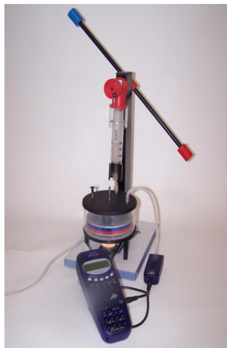
Fig. 1 Struttura dell'esperimento per la registrazione dei valori della pressione di esercizio nel motore Stirling D
