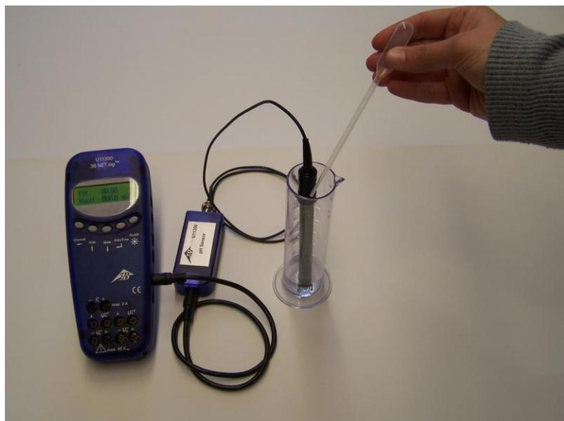
Fig. 1: rilevamento qualitativo della curva di titolazione dell'aceto
