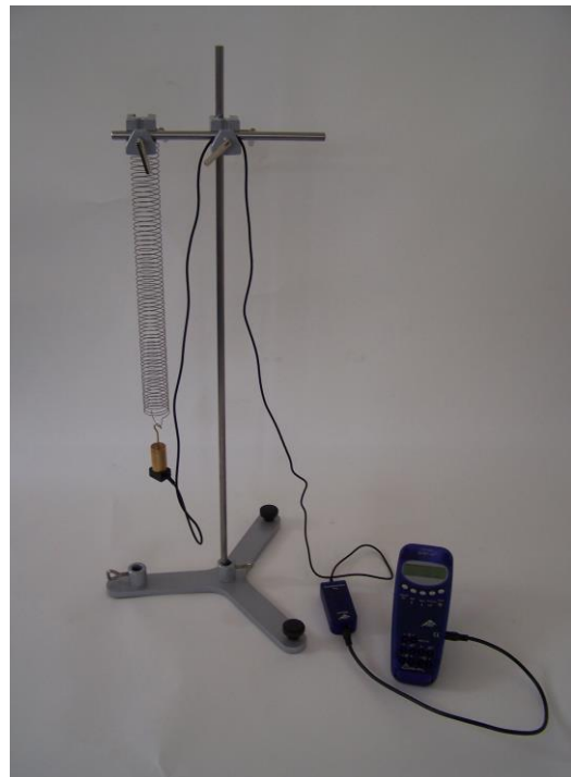
Fig. 1 Misurazione dell'accelerazione di un sistema molla-peso a oscillazione attenuata
