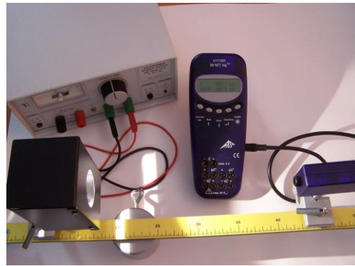
Fig. 1 Misurazione della Legge della distanza quadrata per una sorgente luminosa puntiforme
