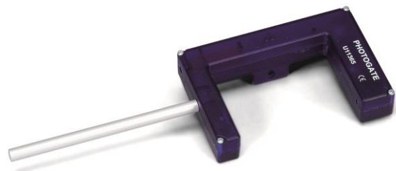
Fig. 1: Con supporto stativo su qualsiasi materiale stativo ad es. per esperimenti con la rotaia a cuscinio d'aria
