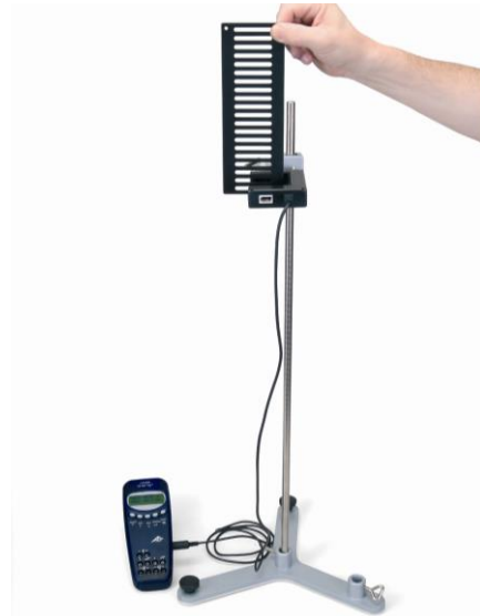
Fig. 5: Misurazione della caduta libera
