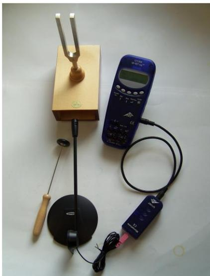
Fig. 1: Misurazione dell'onda sonora di un diapason
