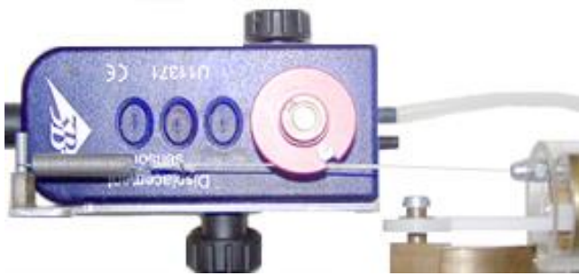
Fig. 2 Montaggio del filo sulla puleggia del rilevatore di corsa
