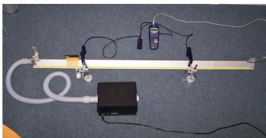
Fig. 1: Misurazione della velocità di un carrello sulla rotaia a cuscino d'aria in caso di distanza predefinita delle fotocellule.
