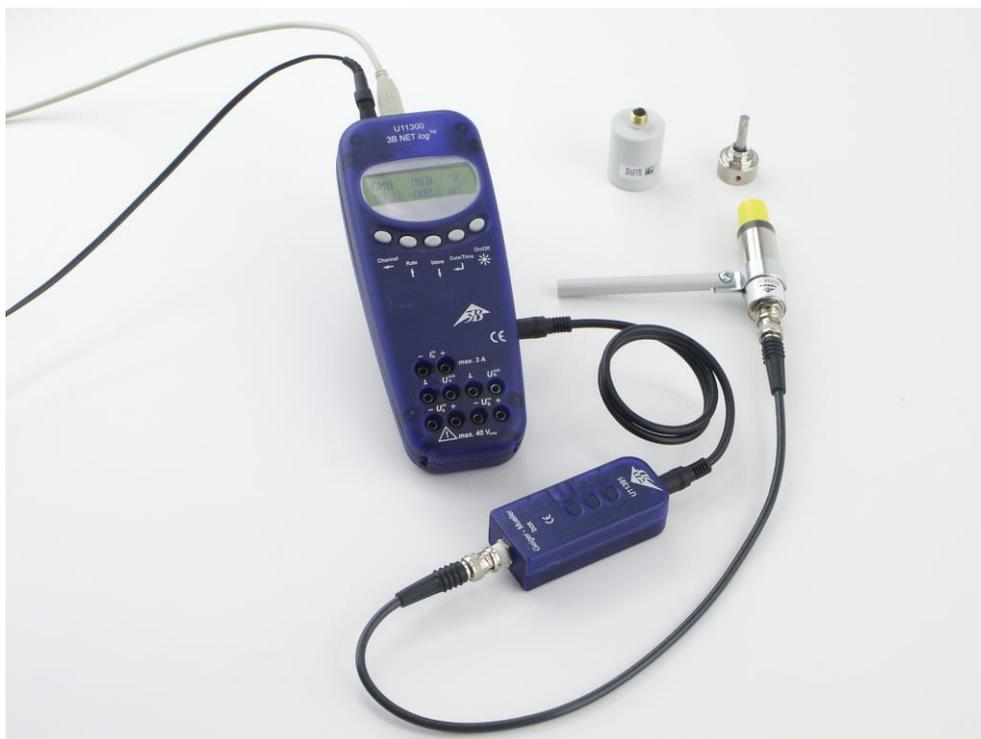
Fig. 1 Struttura dell'esperimento per la registrazione degli eventi di decadimento di una radiazione radioattiva
