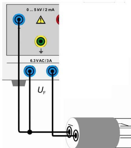
Fig. 2 Cablaggio con adattatore di protezione bipolare
