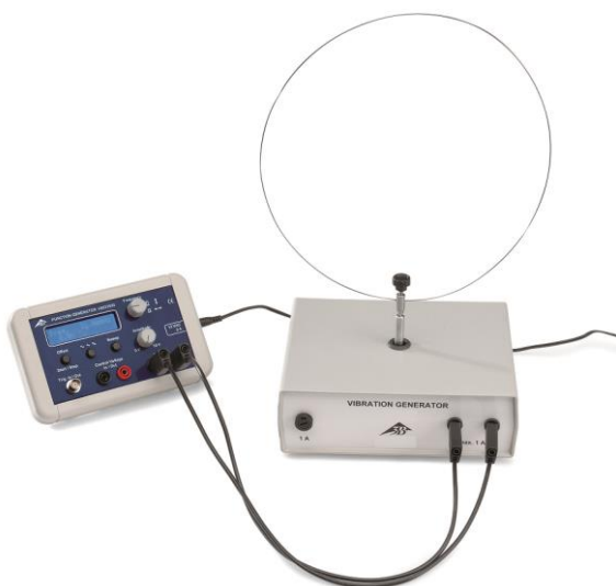
Fig. 3 Struttura sperimentale con il filo di risonanza
