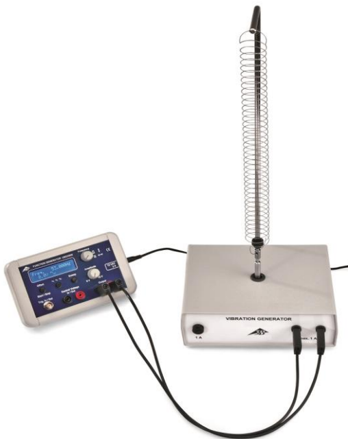
Fig. 2 Struttura sperimentale con l'accessorio per oscillazioni di molle
