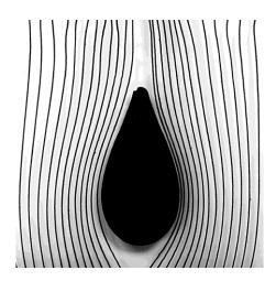
Sottoponendo ad un flusso circolare un corpo con intaglio a goccia, le linee di corrente d'aria si restringono. La velocità della corrente aumenta. Dopo aver superato il corpo, la velocità della corrente diminuisce di nuovo.
