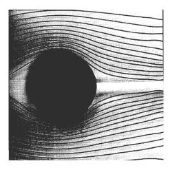
Sottoponendo una sfera ad un flusso circolare, le linee di corrente d'aria si restringono. La velocità della corrente aumenta. Dopo aver superato il corpo, la velocità della corrente diminuisce.
