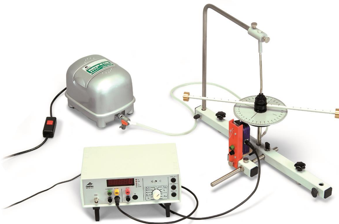
Fig. 2 Struttura sperimentale per la determinazione del momento d'inerzia di un'asta manubrio con masse supplementari con il sensore di riflessione laser (1001034) e il contatore digitale (1001032 o 1001033)
