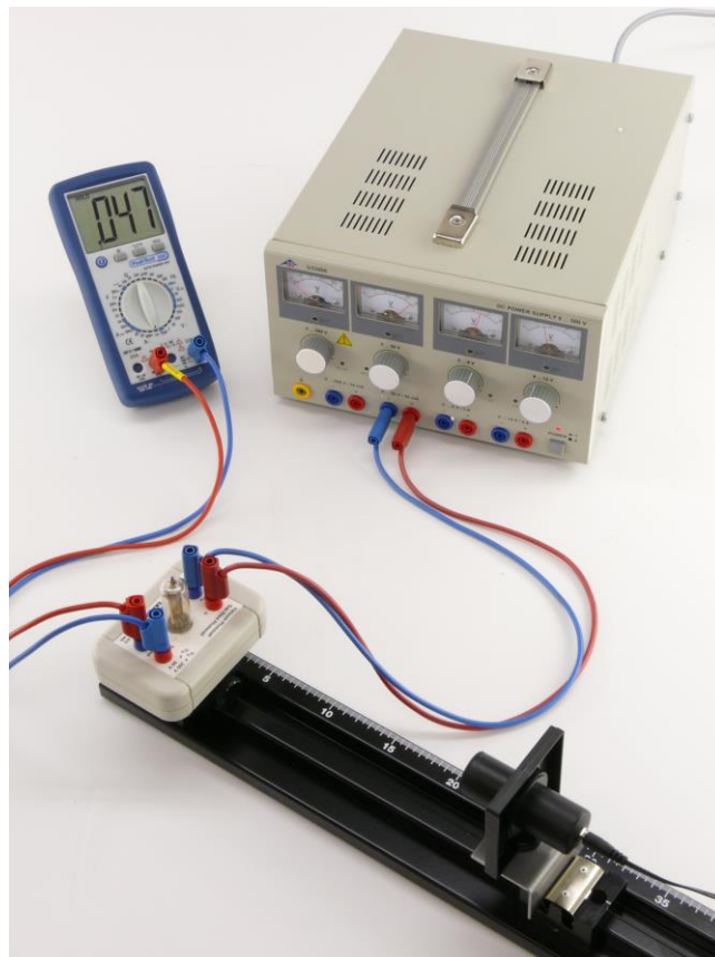
Fig. 2 Struttura sperimentale per la dimostrazione dell'effetto fotoelettrico
