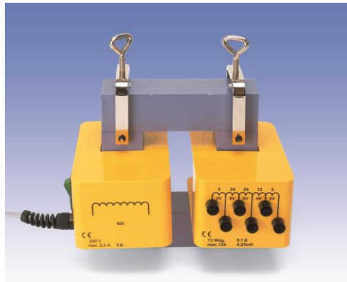
Fig.1 Trasformatore di struttura
