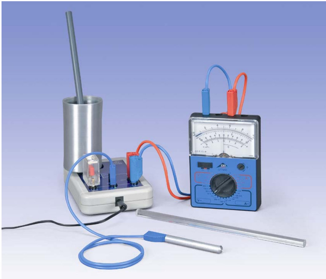
Fig. 1 Struttura sperimentale per la misurazione di cariche nell'ambito dell'elettrostatica
