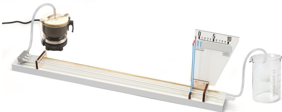
Fig.1 Struttura sperimentale con apparecchio per la dilatazione lineare (1000830)
