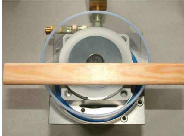
Fig. 9: Allineamento della guarnizione in gomma tonda
