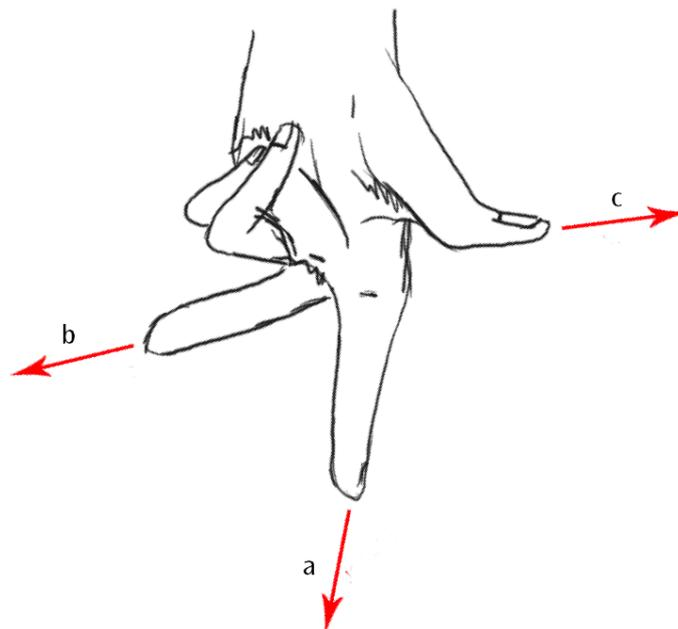
Fig. 2 Regola della mano sinistra (a direzione delle linee di campo magnetico, b direzione della corrente, c direzione di movimento)
