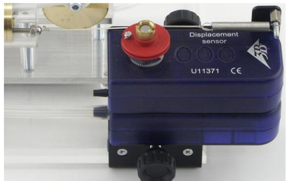
Fig. 6 Allineamento del portasensori
