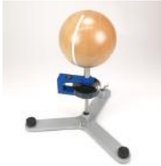
Fig. 6 Determinazione del momento d'inerzia di una sfera
