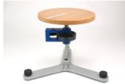
Fig. 4 Determinazione del momento d'inerzia di un disco
