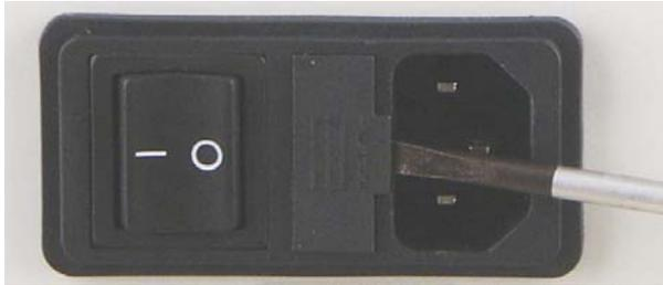
Fig. 3: Sostituzione dei fusibili
