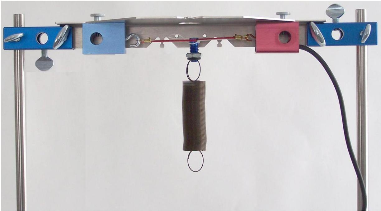
Fig.4 Montaggio della traversa nello stativo
