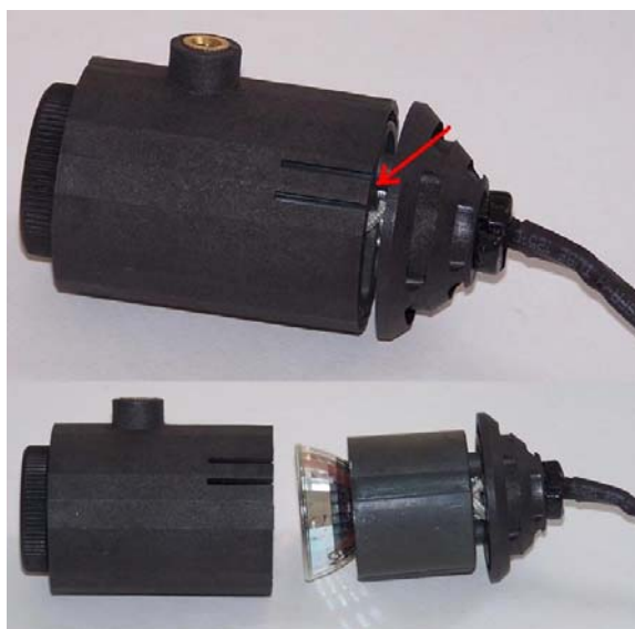
Fig. 1 Sostituzione della lampada della luce dall'alto
