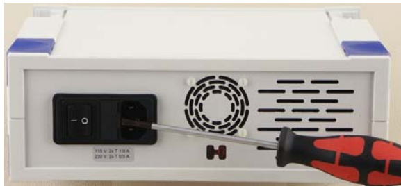
Fig. 1 Sostituzione dei fusibili
