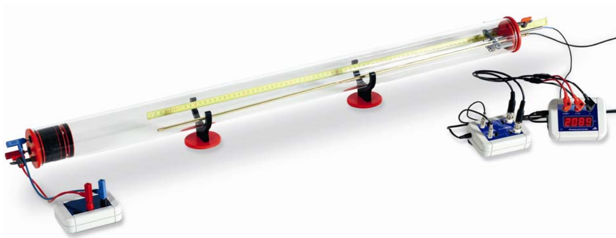
Fig. 1 Struttura sperimentale con il tubo di Kundt
