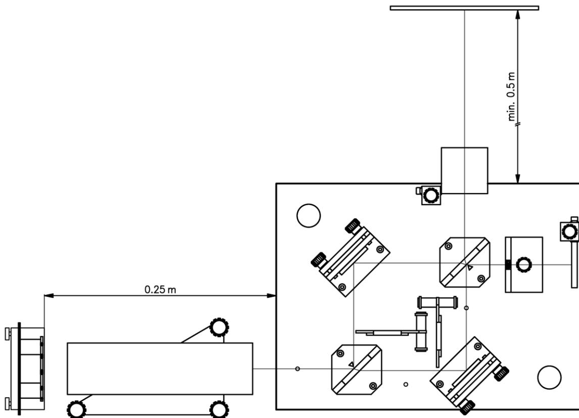
Fig. 11 Struttura sperimentale per l'interferenza di luce bianca
