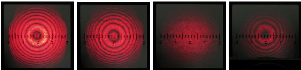
Fig. 10 Da sinistra verso destra: 1. senza filtri di polarizzazione, 2. un filtro di polarizzazione ( $45^\circ$ ) fra lente e divisore di fascio, 3. altri due filtri di polarizzazione ( $0^\circ$  e  $90^\circ$ ) in entrambi i fasci parziali, 4. quarto filtro di polarizzazione ( $45^\circ$ ) fra divisore di fascio e schermo
