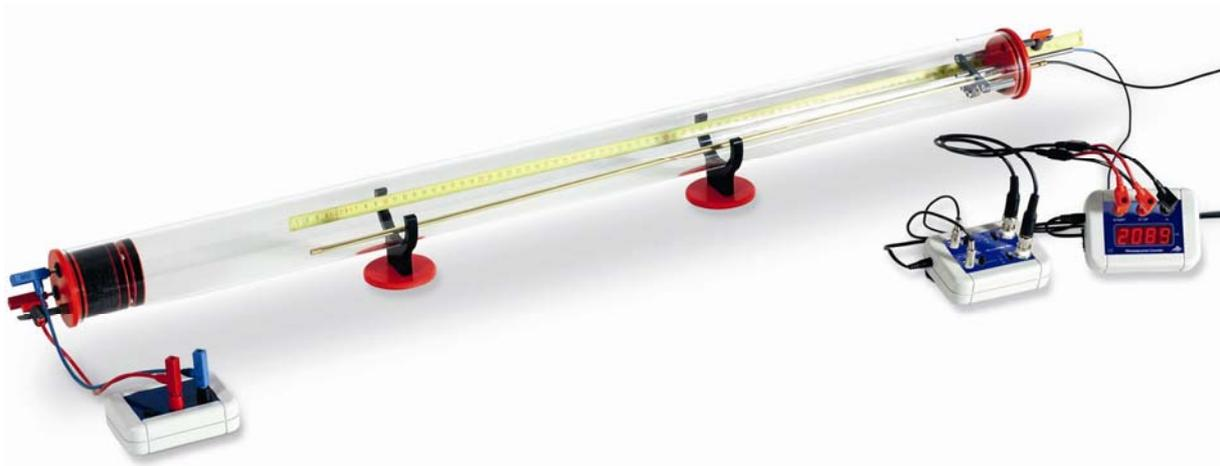
Fig. 2: Struttura sperimentale con il tubo di Kundt
