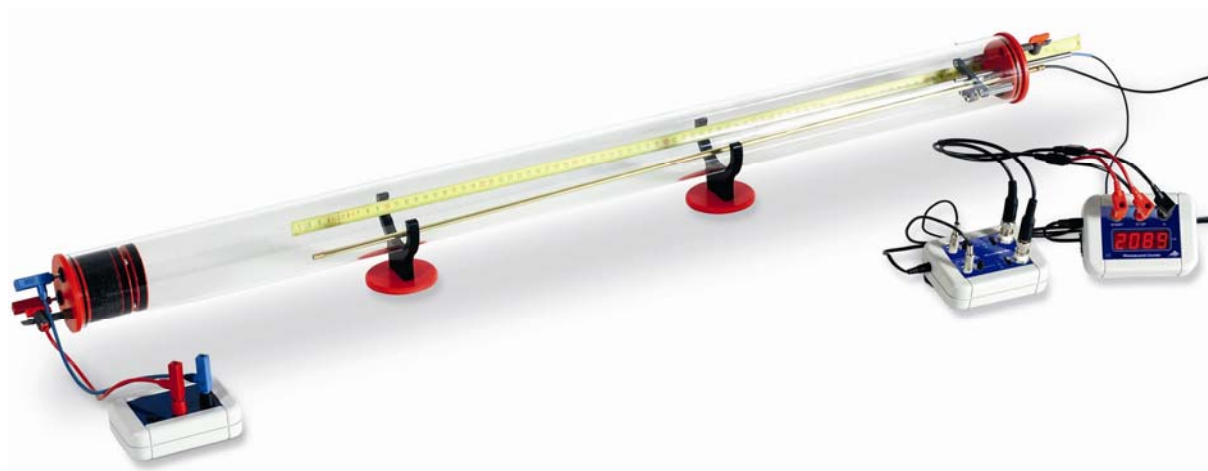
Fig. 2: Struttura sperimentale con il tubo di Kundt
