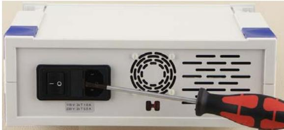
Fig. 1 Sostituzione dei fusibili
