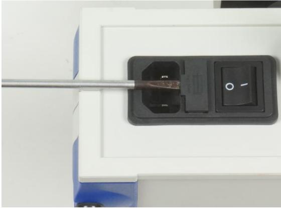
Fig. 1 Sostituzione dei fusibili
