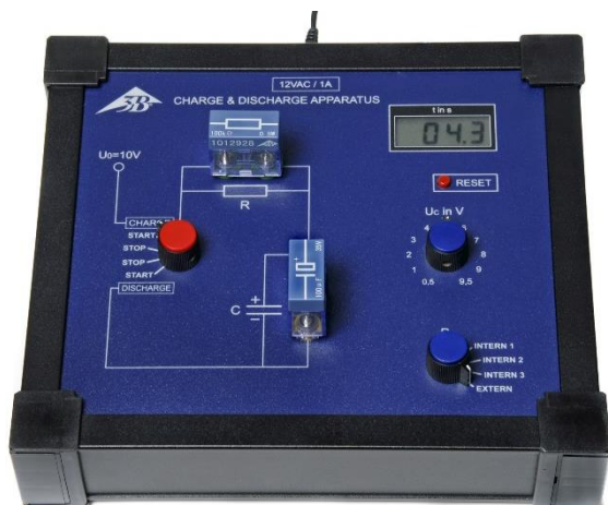
Fig. 1 Misurazione su coppia condensatore/resistenza esterna
