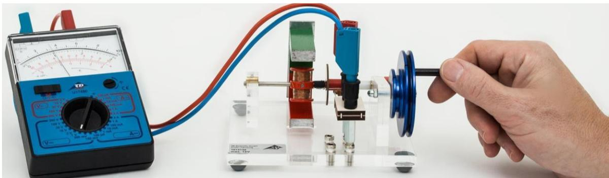
Fig. 3 Funzionamento come generatore di corrente continua con misuratore multiplo ESCOLA 10
