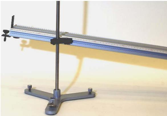
Fig. 20 Manicotto montato per le aste nella scanalatura laterale della rotaia di pulegge
