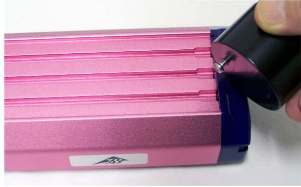
Fig. 22 Inserire la massa aggiuntiva nella scanalatura centrale sul lato superiore del carrello
