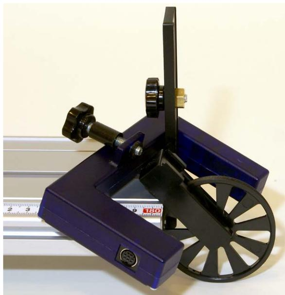
Fig. 11 Montaggio del rullo di rinvio sul fototraguardo
