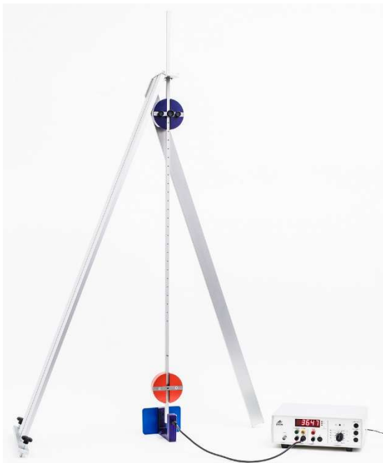
Fig. 5: Struttura sperimentale con fotocellula e contatore digitale
