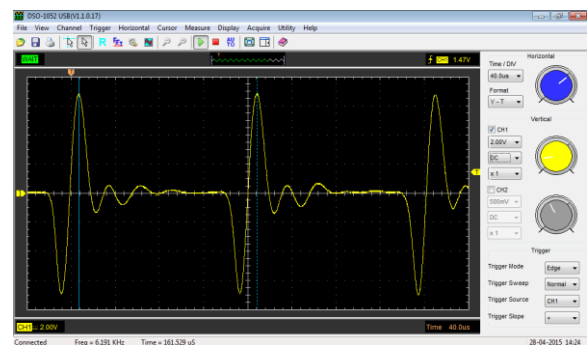
Fig. 2 Treni di oscillazioni in un'asta in acciaio inossidabile da 400 mm dopo un'eccitazione a impulso
