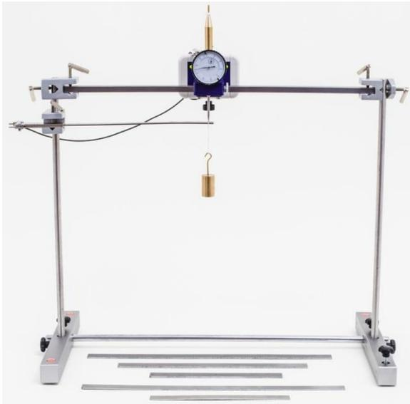
Fig. 2: Struttura sperimentale per campione fissato su un solo lato.
