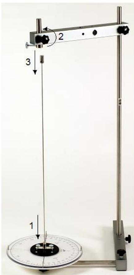
Fig. 5: Avvitamento della barra tonda sul disco del pendolo con l'ausilio della staffa di arresto und inserimento della bussola di serraggio sull'apposito cilindro.
