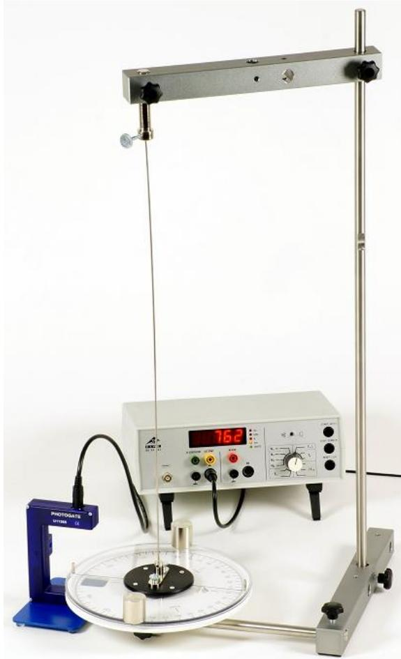
Fig. 10: Misurazione dinamica con fotocellula e contatore digitale.
