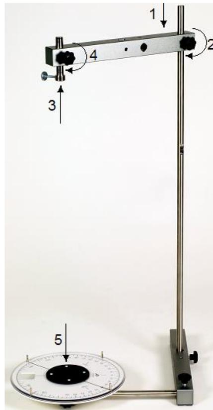
Fig. 4: Montaggio di traversa superiore (per barra tonda da L: 500 mm), bussola di serraggio e disco del pendolo.
