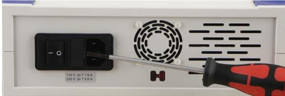
Fig. 2 Sostituzione dei fusibili
