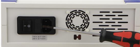
Fig. 2 Sostituzione dei fusibili
