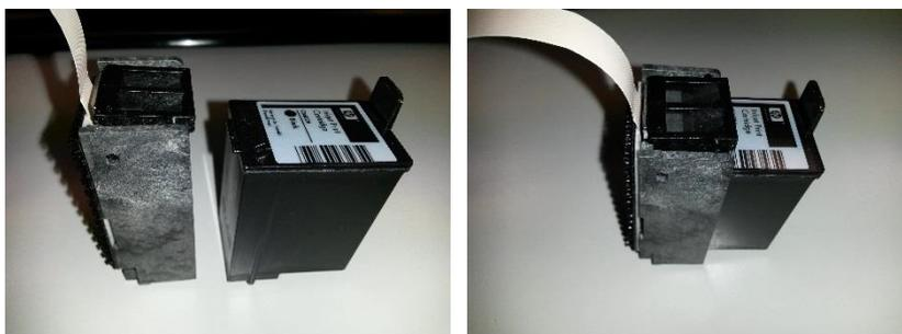
2. Passare il connettore attraverso la finestra della staffa a L con Velcro, quindi fissare con il Velcro il supporto per cartuccia nella staffa a L.
