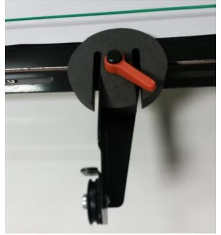
*Puleggia disassata montata su una delle staffe del piano in dotazione (vista da sopra)*
