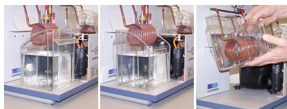
Fig. 3 Fissaggio del contenitore dell'acqua alla pompa di calore
