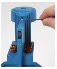
4) Con la chiave a brugola allentare la vite sul lato inferiore del tubo.
