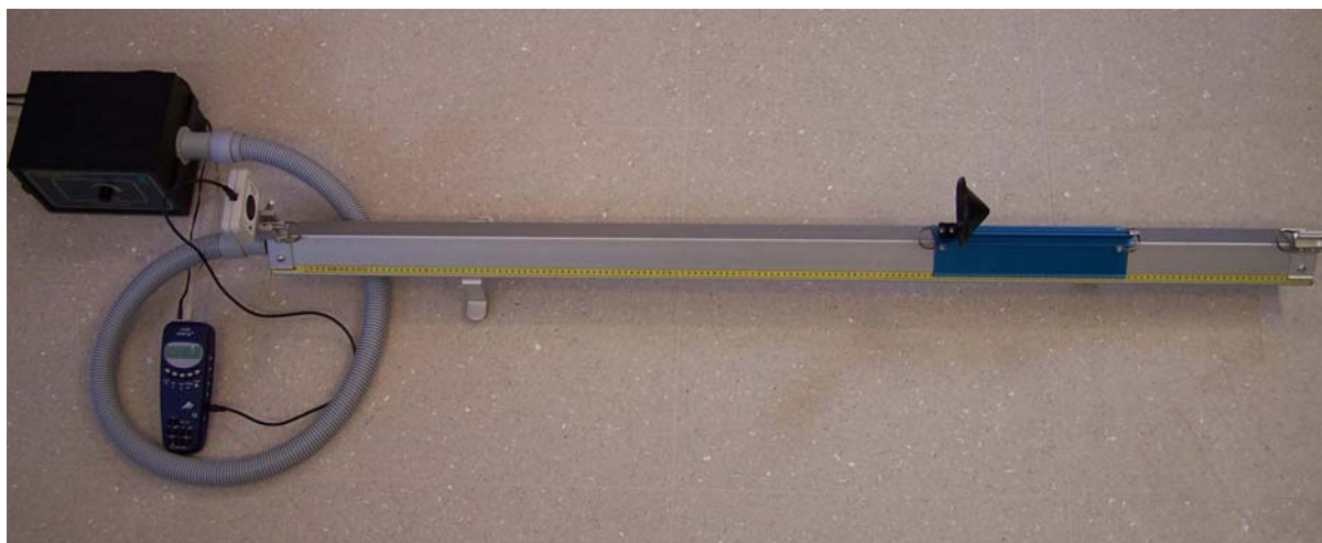
Fig. 1: Struttura sperimentale per la misurazione della velocità sulla rotaia a cuscino d'aria
