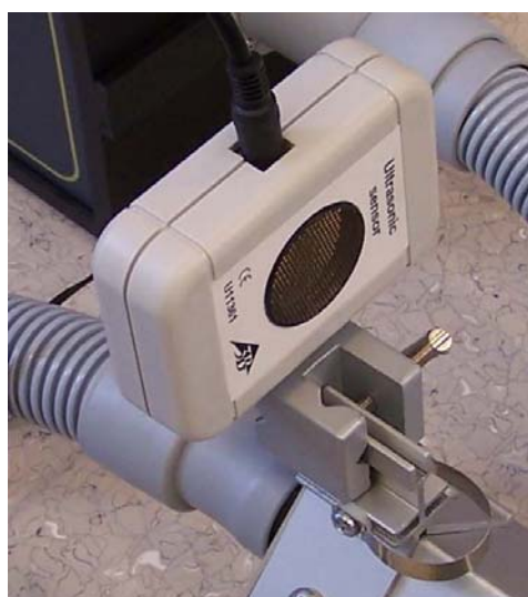
Fig. 2: Vista dettagliata del fissaggio della scatola del sensore sulla rotaia a cuscino d'aria
