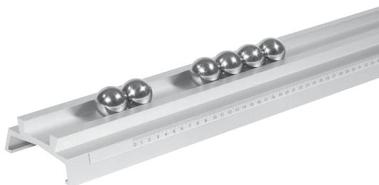
Trilho corrediço com esferas, adequadas para experiências com impacto elástico sobre um trilho. Temperadas e polidas.
