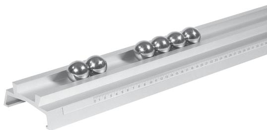
Sfere di acciaio idonee per prove d'urto elastico e non elastico su una guida di scorrimento.
